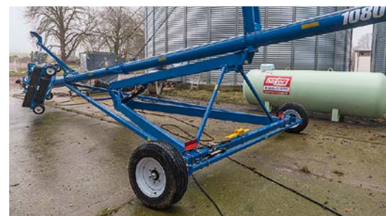
Dank der hydraulisch gelenkten Achse lässt sich die Schnecke präzise platzieren.
