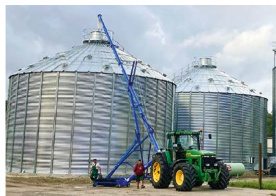
Die Schnecke als zweite Annahmemöglichkeit ist für den Betrieb einer der Hauptvorteile des Systems.
