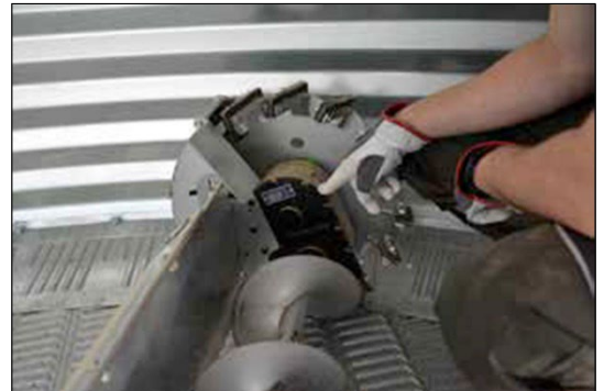
Prüfung des Übersetzungsgetriebes am Schaufelrad
