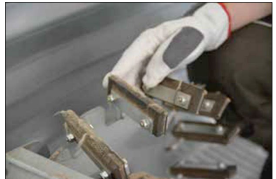
Prüfung der Gummilippen am Schaufelrad
