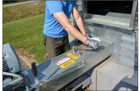
Öffnen und Schließen der Schieber
