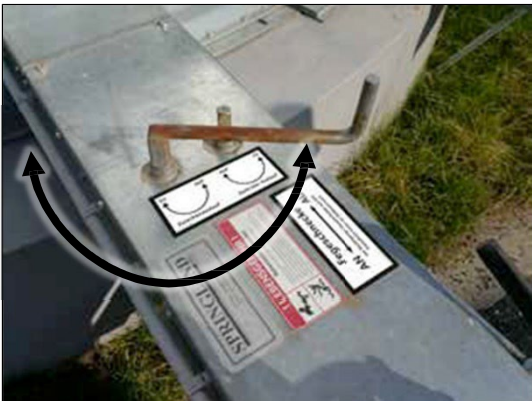
Position Kurbel zur Bedienung des Zwischenschiebers
