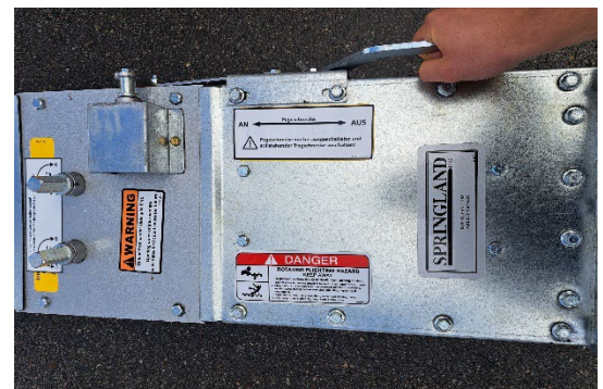
Seitlicher Hebel zum Ein- bzw Auskuppeln des Getriebes
